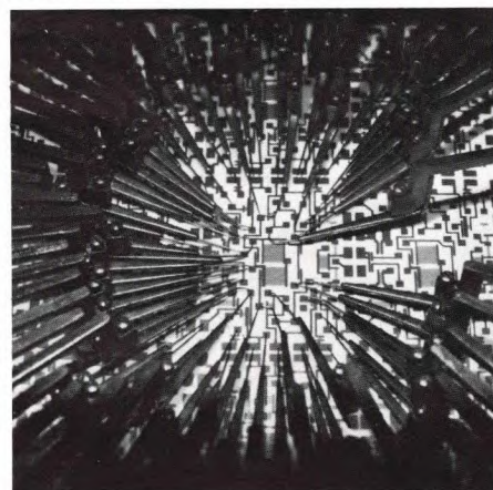
Afb. 4. Een bundel meetpennen bij het controleren van de werking van een dunnetilm schakeling.
